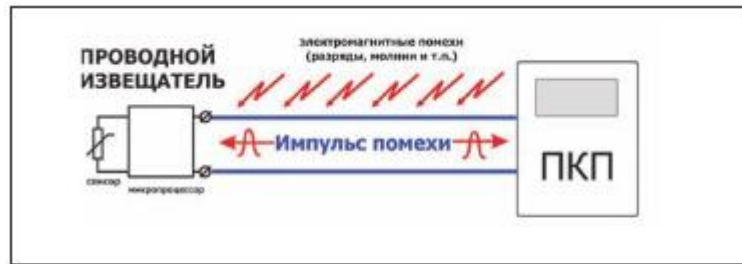
Рис. 1. Индуктивная помеха создается под действием внешнего электромагнитного поля
