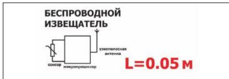
Рис. 6. Помехи для беспроводного извещателя. L – длина антенны
